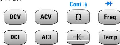
연속 및 다이오드 테스트 기능은 **Shift** 키를 통해 변환됩니다(파란색으로 표시). 예를 들어 연속을 선택하려면 다음을 누릅니다.
