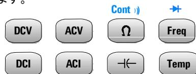
導通およびダイオード・テスト機能はシフト機能です(青で表示)。例えば、導通測定を選択するには、次のようにキーを押します。
