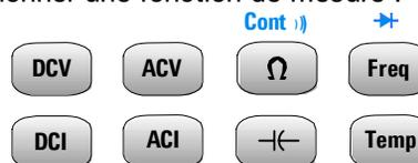
Les fonctions de continuité et de test de diode sont accessibles via la touche Shift (en bleu). Par ex., pour sélectionner continuité, app. sur :
