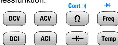
Die Durchgangs- und Diodentestfunktion (blau) erfordern die Umschalttaste. Die Durchgangstestfunktion wählen Sie so:
